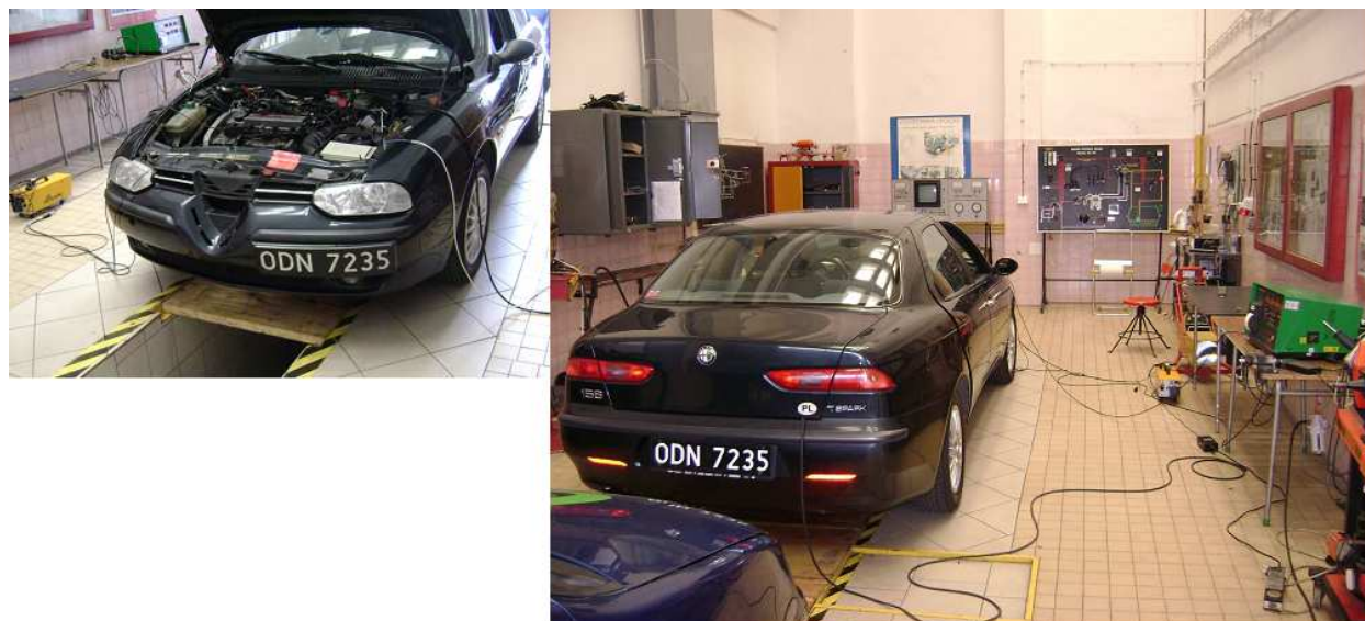
Test emisji substancji szkodliwych dla samochodu badawczego – Alfa Romeo 1.8 Twin Spark
