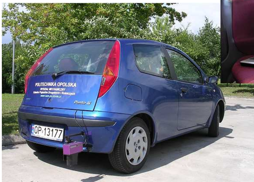
Pojazd badawczy- Fiat Punto z system pomiarowym DaqBook 100 firmy IoTech
