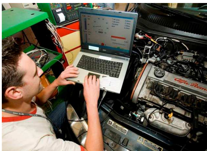
Programowanie ECU silnika ZI zasilanego wodorem
